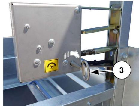
Abb. 49: Notentriegelung Rampe / Beladetür innen
