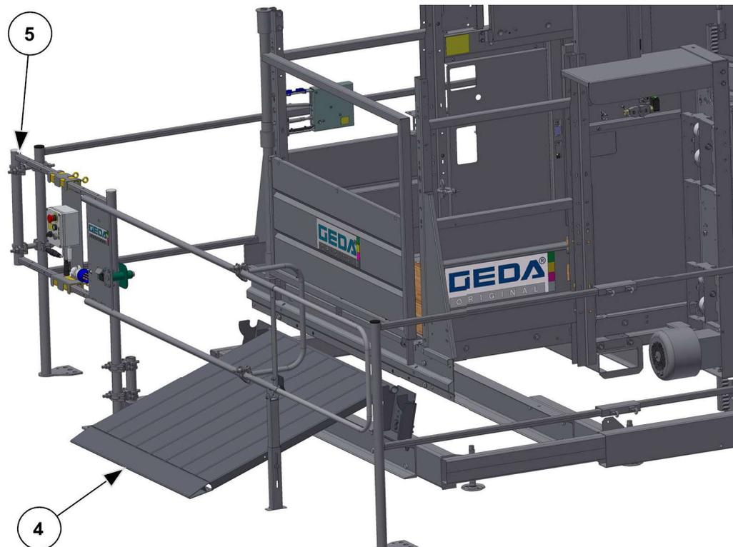
Abb. 50: Auffahrrampe am Bühnenzugang Bodenstation
