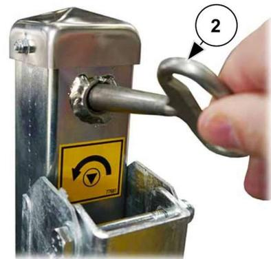
Abb. 57: Notentriegelung der Schranke mit elektromechanischer Verriegelung
