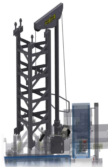
Abb. 97: Anheben, Positionieren von Mastteilen
