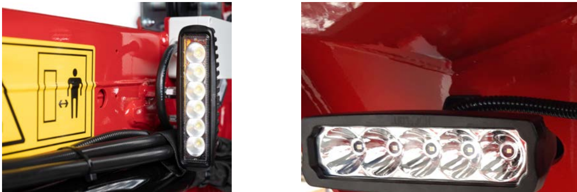
Abbildung 2.12 Zwei Arbeitsleuchten am Kran.
