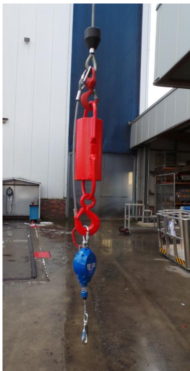
Abb. 10-31 Redundante Sicherung am Kranhaken
