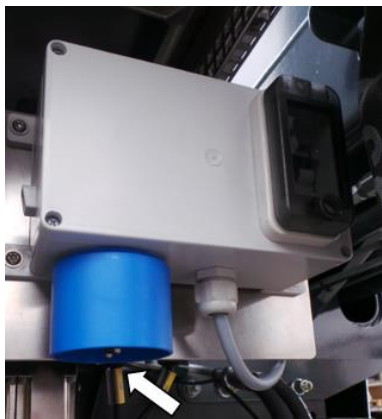
Abb. 11-1 Einspeisung für Steckdose 230 V (10A)
