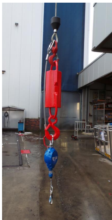
Abb. 10-26 Redundante Sicherung am Kranhaken
