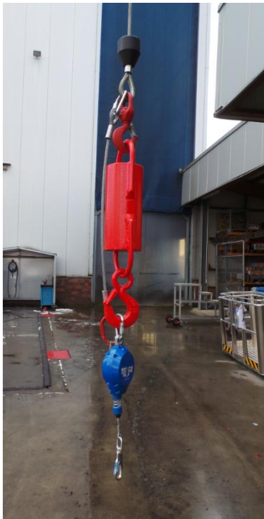
Abb. 10-35 Redundante Sicherung am Kranhaken
