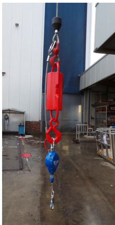
Abb. 10-30 Redundante Sicherung am Kranhaken
