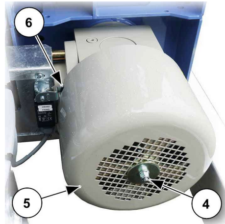
Abb. 104: Fangvorrichtung mit Endschalter
