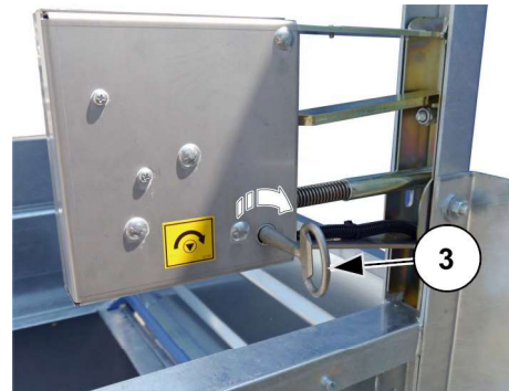
Abb. 49: Notentriegelung Rampe / Beladetür innen
