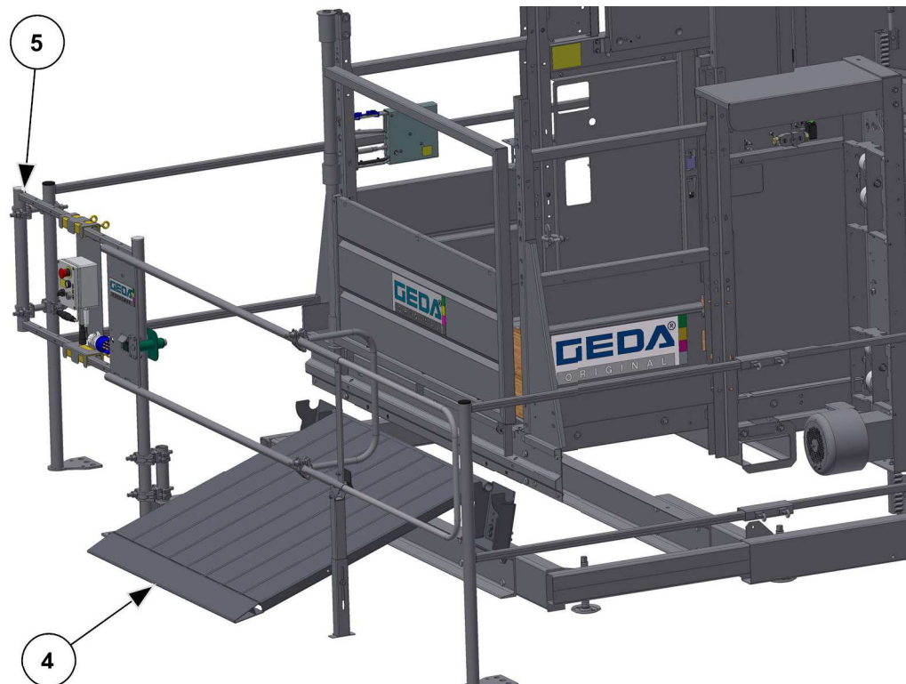
Abb. 50: Auffahrrampe am Bühnenzugang Bodenstation
