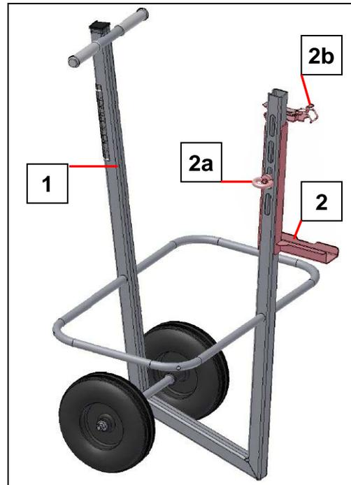
Zur Anpassung an unterschiedlichen Gerüsten kann die Maschinenhalterung(2) mit der Ringschraube (2a) in drei verschiedenen Positionen verschraubt werden. (Verstellbereich 80 mm [31 in] nach oben und unten).
