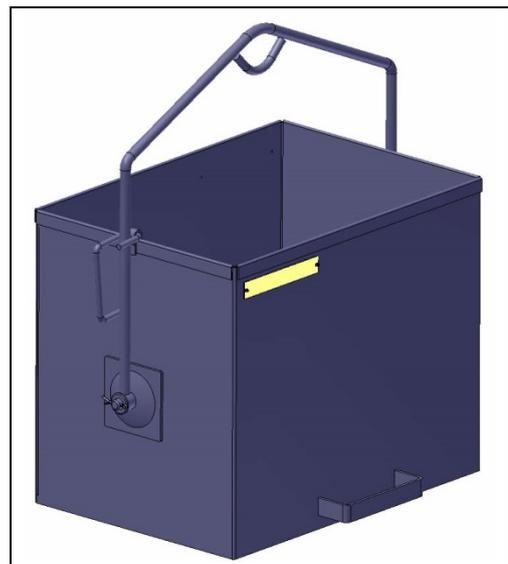
➤ Zum Auskippen Sicherung (2) öffnen und Kübel (1) kippen.
