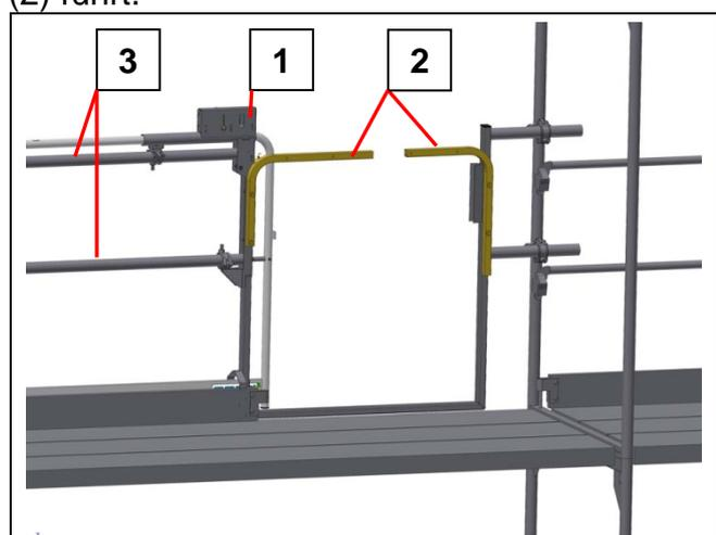
Bei großen Gerüstfeldbreiten ist ggf. zusätzlich die Montage von entsprechend langen horizontalen Gerüstrohren (3) zur Befestigung notwendig.
