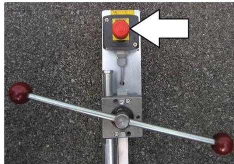
Abb. 14 b: NOT-AUS-Schalter (Pfeil) an der Fernbedienung (optional)
