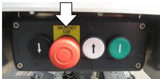
Abb. 15 b NOT-AUS Schalter am Kopfstück
