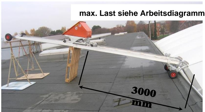
Abb. 85: Belastung und Abstützung bei max. Last
