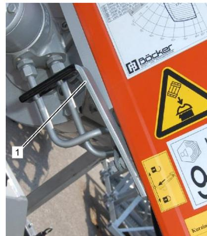
Abb. 101: Hebel Arretierung Schienenpaket
