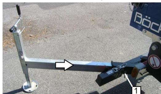
Abb. 37: Hintere Stützen einsetzen
