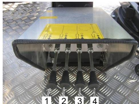
Abb. 41: Vordere Stützen absenken
