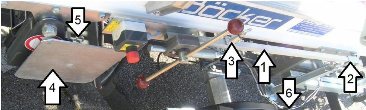
Abb. 43: Mechanische Fernbedienung
