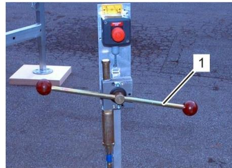
Abb. 89: Bedienhebel Schlitten
