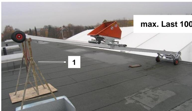
Abb. 86: Belastung und Abstützung bei 100 kg Last
