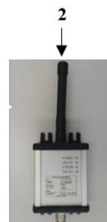
Abb. 6-7 Funkfernbedienung Empfänger
