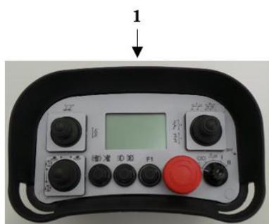
Abb. 6-15 Funkfernbedienung Sender
