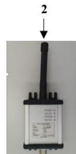
Abb. 6-2 Funkfernbedienung Empfänger
