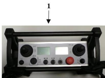
Abb. 6-8 Funkfernbedienung Sender
