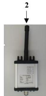
Abb. 6-21 Funkfernbedienung Empfänger
