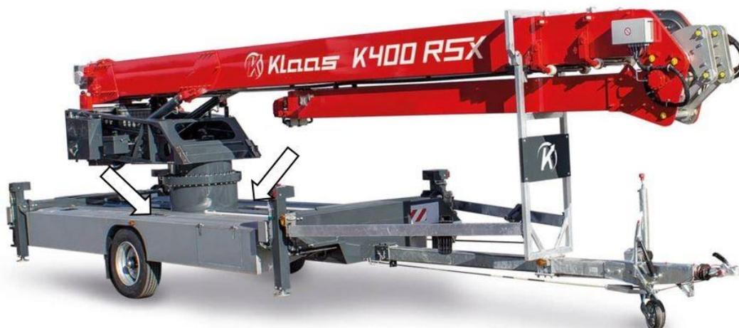
Abb. 7-2 Transportposition für Selbstfahrantrieb
