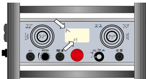
Abb. 4-13 Windgeschwindigkeit kleiner 12,5 m/s (45 km/h)
