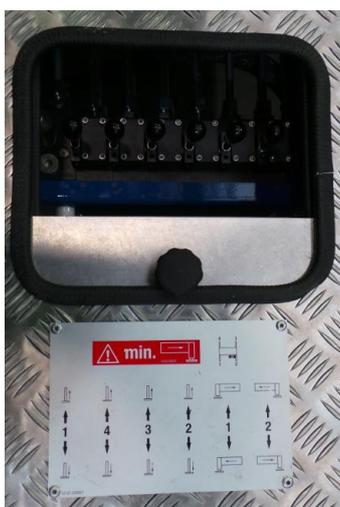
Abb. 8-36 Stützensteuerblock Fahrerseite
