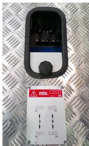
Abb. 8-37 Stützensteuerblock Beifahrerseite
