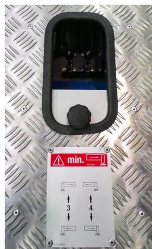
Abb. 5-4 Stützensteuerblock (Beifahrerseite)
