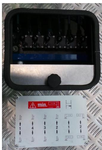
Abb. 5-5 Stützensteuerblock (Fahrerseite)
