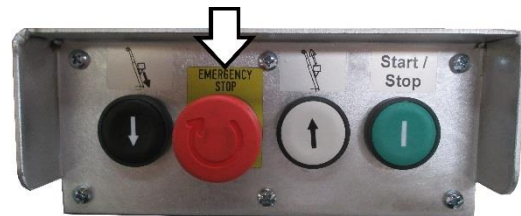
Abb. 14: Not-Aus am Kopfstück
