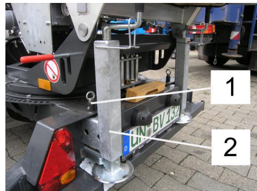
Abb. 116: Hintere Stütze eingeschoben
